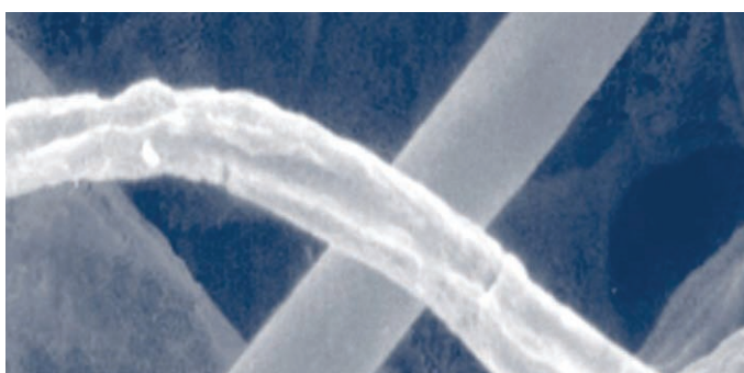
Mezzi per setti filtranti (600px) – I mezzi convenzionali hanno spazi fino a 60 µm tra le fibre, consentendo alla polvere di essere intrappolata a fondo.
