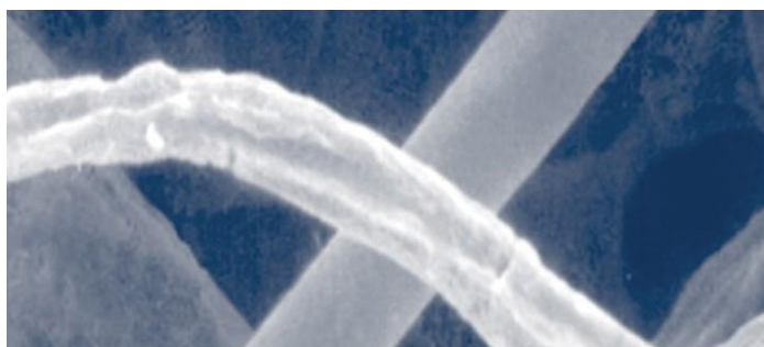
Mídia de filtro comum (600px) - A mídia convencional tem espaços de até 60 mm entre as fibras, permitindo que a pó se aloje profundamente.
