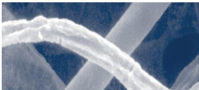
Medio filtrante para productos básicos (600px) – El medio filtrante convencional tiene espacios de hasta 60 µm entre las fibras, lo que permite que el polvo se incruste profundamente.
