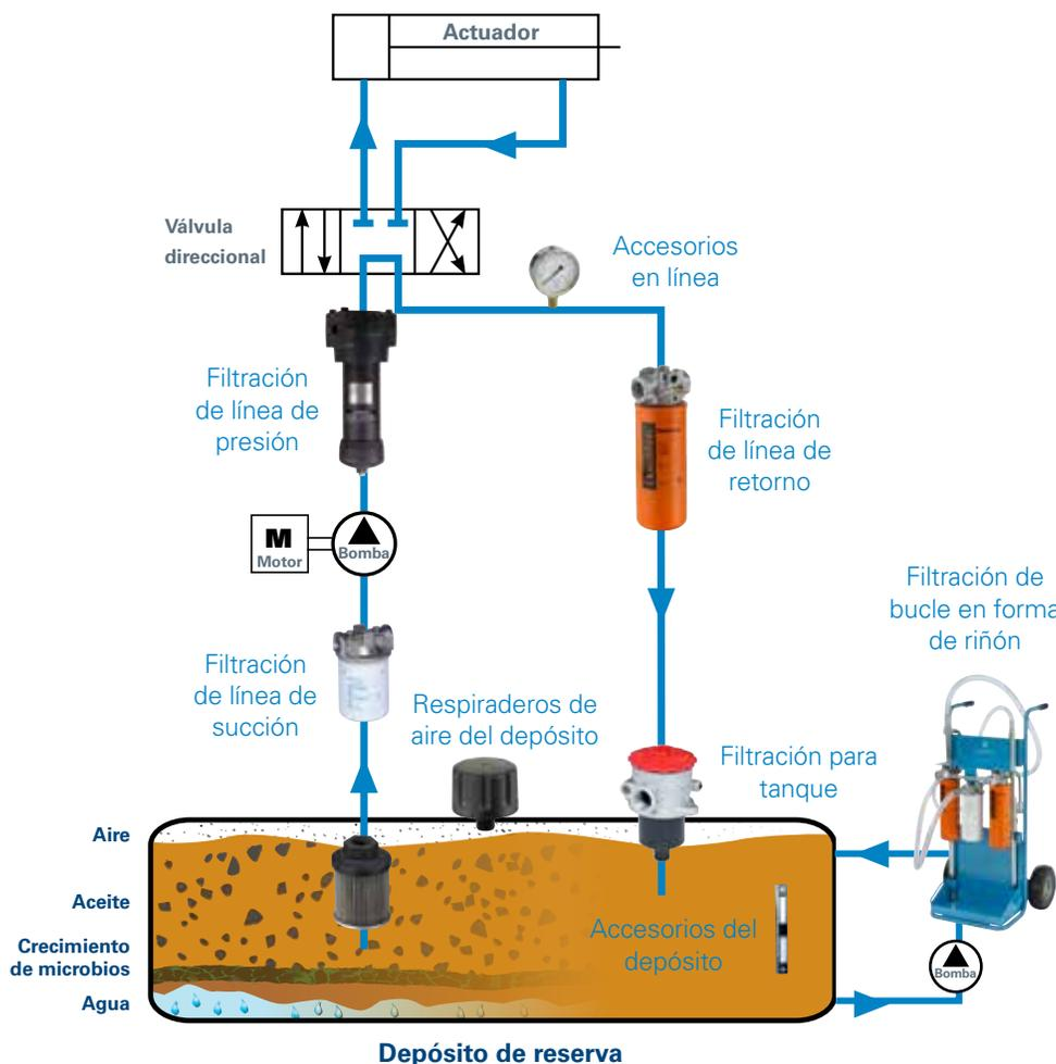
El agua en los tanques del depósito es una seria amenaza a los sistemas hidráulicos. La suciedad, las partículas y el crecimiento de microbios también son contaminantes comunes existentes en los tanques.
